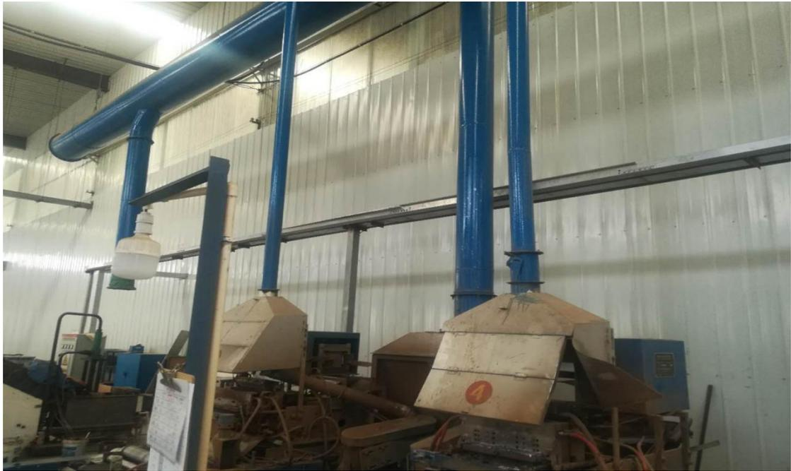
实施改造后 8 台铸板机全部加装了调节阀门
